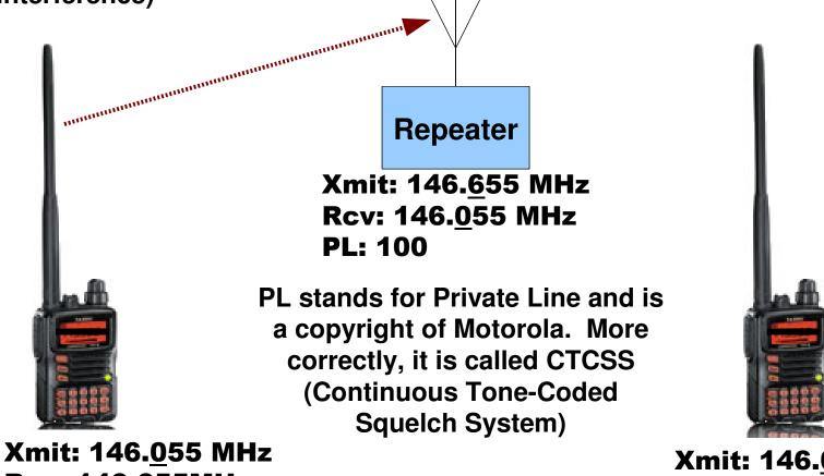
Xmit: 146.<u>0</u>55 MHz Rcv: 146.<u>6</u>55MHz PL: Not 100 Xmit: 146.<u>0</u>55 MHz Rcv: 146.<u>6</u>55MHz
