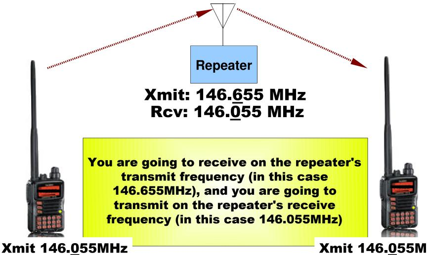
Xmit 146.<u>0</u>55MHz Rcv 146.<u>6</u>55Mhz Xmit 146.<u>0</u>55MHz Rcv 146.<u>6</u>55Mhz
